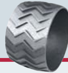
Radstudie des Mondfahrzeuges als CAD- und FEM-Modell.
