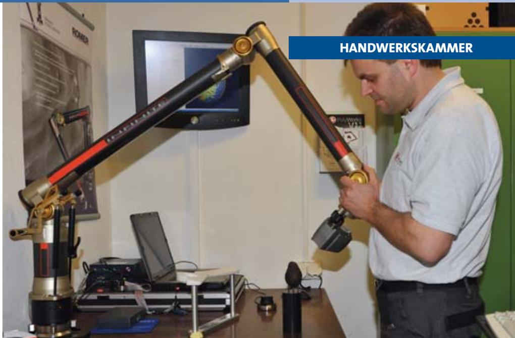
Fertigungsleiter Udo Gehrmann demonstriert an einer Avocado, was mit dem 3D-Scan möglich ist. Oben wird die Frucht gescannt und ist dann auf dem Computerschirm abgebildet (rechts).
